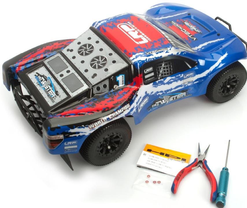
**Benötigtes Material:** eine Flach- oder Kombizange zum Lösen der Spurstangen, einen kleinen Schraubendreher oder eine lange Pinzette zum Einsetzen des O-Ringes; 2-Silikon O-Ringe wie z.B. #H6819
