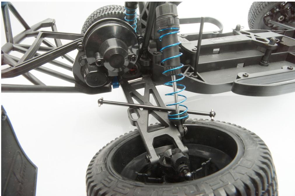
Setzen Sie den O-Ring in den Differentialabtrieb.
