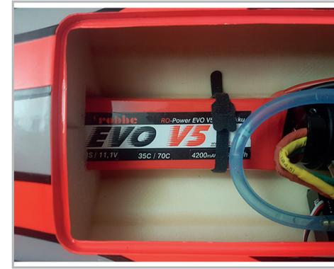
Der 3S LiPo Fahrtakku wird mit Hilfe von lösbaren Kabelbindern oder Klettbindern auf dem vorderen Akkubrett befestigt.
