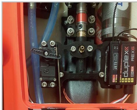
Montieren Sie den Empfänger (nicht enthalten) gegenüber dem Lenkservo mit einem Kabelbinder.
