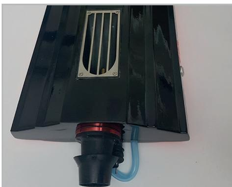
Prüfen Sie vor und nach jeder Fahrt den Jet-Antrieb auf grobe Verschmutzungen oder Beschädigungen im Einlass- und Auslassbereich.
