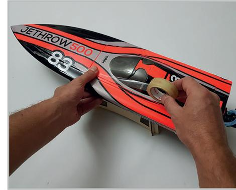
Sind diese Arbeiten abgeschlossen kann die Haube auf den Rumpf gesetzt werden und umlaufend mit beiliegendem Tape wasserdicht mit dem Deck verklebt werden.
