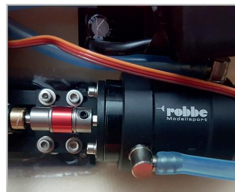
Prüfen Sie durch Drehen an der Wellenkupplung regelmäßig die Leichtgängigkeit der Welle und ölen diese alle fünf Akkuladungen nach. Es befindet sich ein kleiner Schmiernippel oberhalb der Welle, in den das Öl eingefüllt wird.
