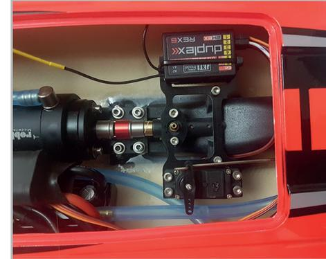
Schließen Sie das Servo und den Robbe Ro-Control Navy an den Empfänger gemäß der Bedienungsanleitung Ihrer Fernsteuerung an.
