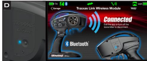
5. L'icône Bluetooth® dans la barre d'état s'allume d'une couleur bleu constant, et le voyant DEL du module s'allume d'une couleur bleu constant (D).
