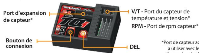
\*Port de capteur accessoire à utiliser avec le module d'extension de télémétrie
