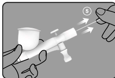
Vytiahnite ihlu (5). Ihlu vyčistite malým množstvom čističa na airbrush tak, že ju utierate výhradne smerom k ostrému hrotu. Ihlu vždy utierajte zo zadu dopredu, aby ste predišli poraneniu. Ihly sú mimoriadne ostré a zároveň veľmi krehké.
